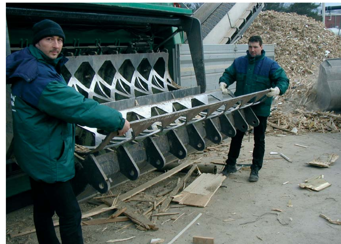
Einfacher und schneller Siebkorbwechsel für verschiedene Korngrößen
