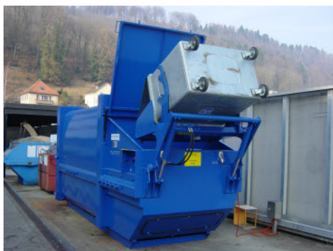
Presscontainer mit angebauter Hubkippvorrichtung für 800 lt Container und/oder für Kammaufnahme von Kunststoffbehälter 140 – 770 lt.
