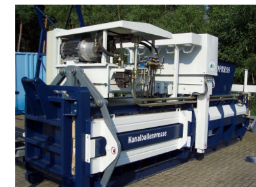
Die meisten Kanalballenpressen sind problemlos transportierbar und können mit einem Hakenfahrzeug auf- und abgeladen werden.
