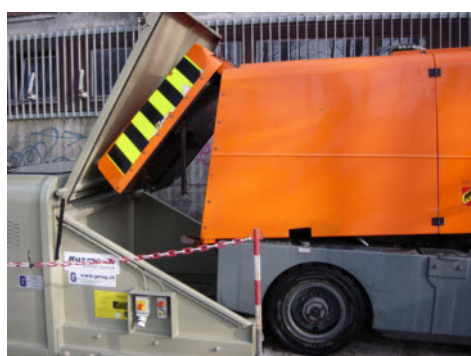
Selbstpresscontainer wird direkt aus der städtischen Wischmaschine befüllt.
