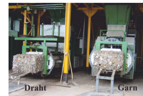
Zwei parallel im Einsatz stehende Pressen, links mit konventioneller Drahtabbindung, rechts mit Garnbändern.
