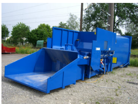
Selbstpresscontainer für Sonderanwendung. Hubkippvorrichtung als Ladeschaukel für den Einsatz auf Werkhöfen und in Industriebetrieben.
