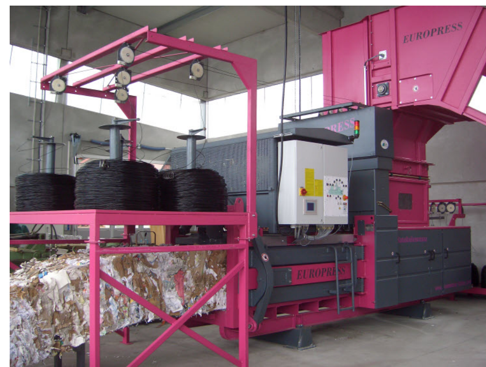
EUROPRESS-Kanalballenpresse Typ 8100 VGSK mit 90t Presskraft, im Einsatz in einem Sortierwerk.
