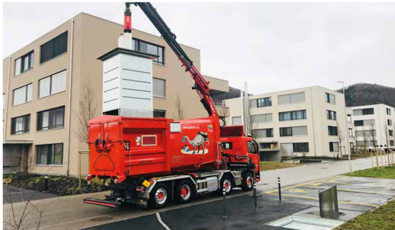
«Der Presscontainer auf dem LKW ist die optimale Lösung für die Leerung von Unterflurbehältern», sagt Betreiber Peter Pfister.
