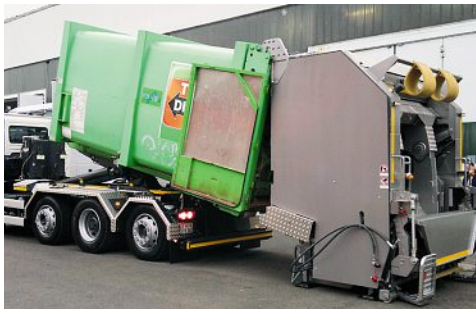
Ein konventioneller Hakenabroller wird zum Abfallsammelfahrzeug
