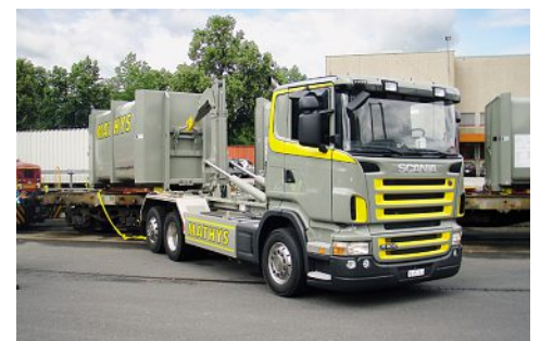
Voller Pressbehälter wird auf den ACTS-Bahnwagen verladen
