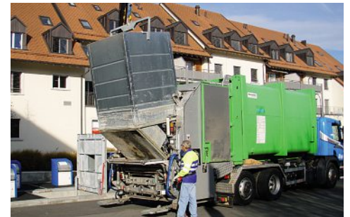
Entleerung des Unterflurbehälters in das CTS 2000
