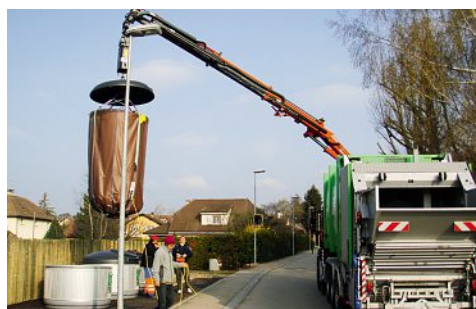
Récupération d'un collecteur enterré
