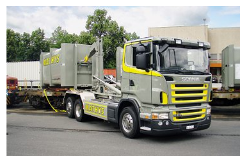
Un conteneur à presse plein est transposé sur le wagon ACTS
