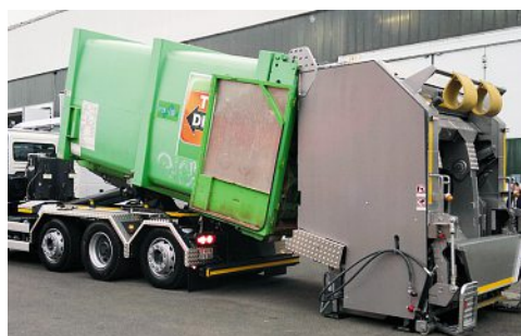
Un Multi-lift conventionnel se transforme en véhicule de ramassage des ordures
