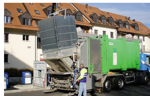
Vidange d'un collecteur enterré dans le CTS 2000
